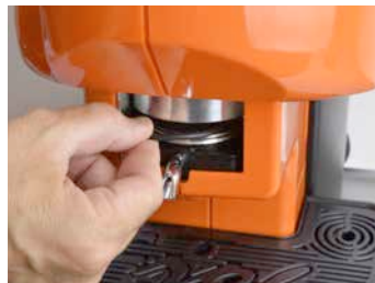
Fig. 6.1-D Inserimento nuova guarnizione
