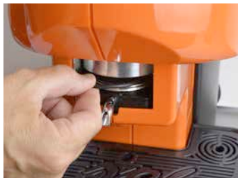
Fig. 6.1-D Inserimento nuova guarnizione
