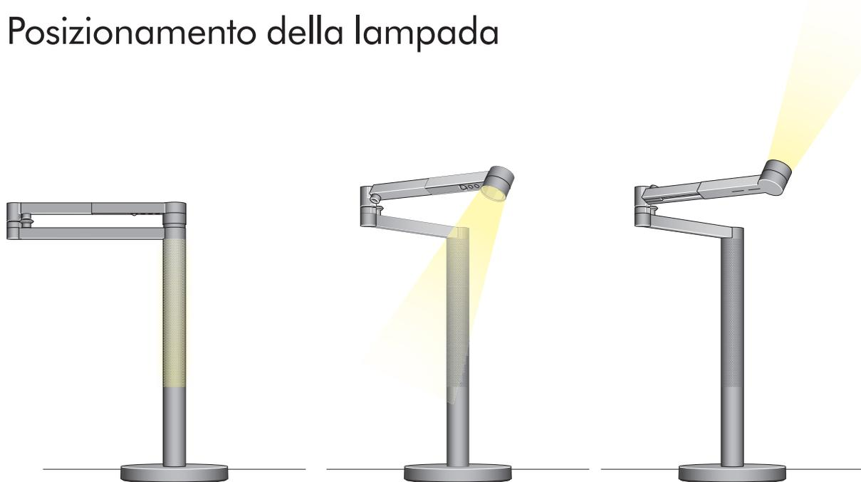
Puoi modificare la posizione della lampada ruotando in maniera indipendente la testa ottica, il braccio e il corpo centrale fino a 360°.
