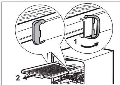
2. Spostare il cestello superiore sul livello inferiore per raggiungere il mulinello superiore con maggiore facilità.
