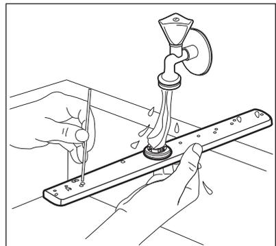
4. Per re-installare il mulinello, premere il mulinello stesso verso l'alto e contemporaneamente ruotarlo in
