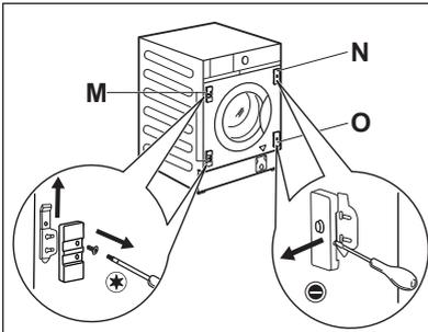
Se la porta del mobile deve essere aperta da sinistra a destra, invertire la posizione dei supporti cerniera **M** con la piastra magnetica **N** e la piastra inferiore **O**.
