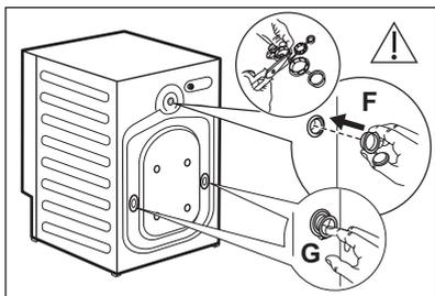
7. Chiudere i fori con i cappucci in plastica presenti nel sacchetto del manuale dell'utente. Mettere il cappuccio più piccolo **F** nel foro superiore e i due cappucci più grandi **G** nei fori inferiori.
