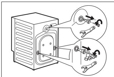
6. Togliere i tre bulloni, i supporti del tubo flessibile e i distanziatori in plastica servendosi del distanziatore fornito in dotazione con l'apparecchiatura.
