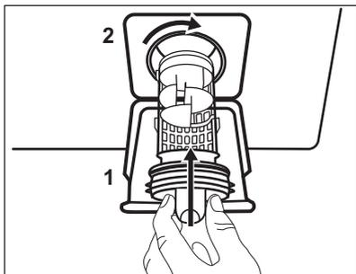
9. Ricollocare il filtro nelle guide speciali ruotandolo in senso orario. Accertarsi di chiudere correttamente il filtro per evitare perdite.
