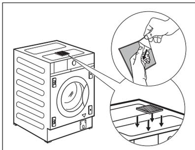
L'apparecchiatura è inoltre dotata di un cuscinetto-spugna adesivo H che si trova all'interno del cestello.
