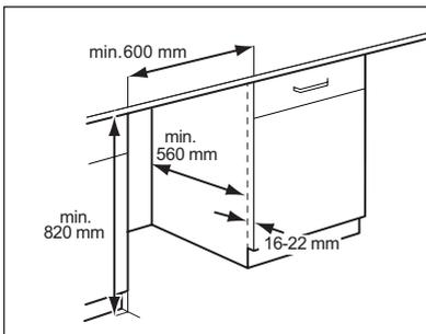
Questa apparecchiatura è stata progettata per il montaggio a incasso in un mobile. Vedere le dimensioni di incasso minimo negli schemi.
