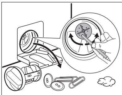
7. Se necessario, togliere la lanugine e gli oggetti dall'incasso del filtro. Assicurarsi che il girante della pompa possa ruotare. Se non ruota, contattare il Centro di Assistenza Autorizzato.
