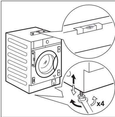
1. Installare l'apparecchiatura su un pavimento piano e solido.
