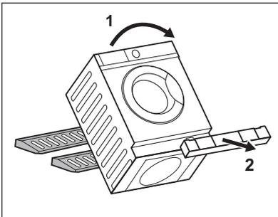
4. Riportare l'apparecchiatura in posizione verticale e togliere la protezione zoccolo in polistirolo.
