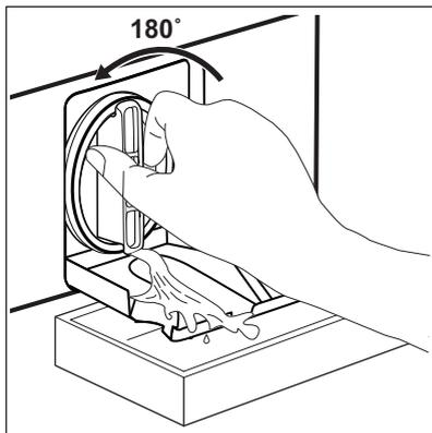
3. Ruotare il filtro di 180 gradi in senso antiorario per aprirlo, senza rimuoverlo. Lasciare che l'acqua fuoriesca.
