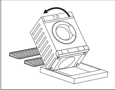
1. Appoggiare gli elementi dell'imballaggio in polistirolo sul pavimento, sotto all'apparecchiatura.
