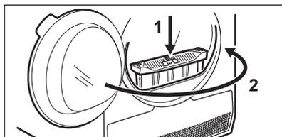
1) Se necessario, pulire il filtro con la spazzola e acqua di rubinetto calda e/o un aspirapolvere.
