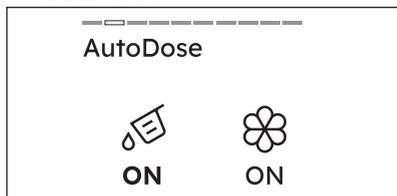
2. Toccando il tasto funzione sinistro il serbatoio del detersivo può essere abilitato/disabilitato e impostato in modalità ON od OFF. Toccando il tasto funzione destro il serbatoio dell'ammorbidente può essere abilitato/disabilitato e impostato in modalità ON od OFF
