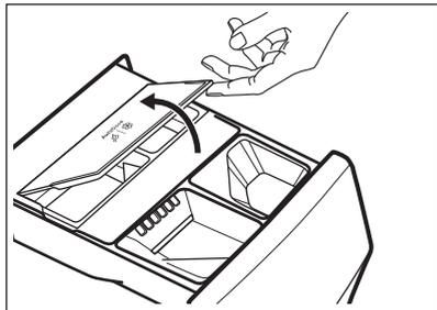
3. Versare delicatamente solo detersivo liquido nel serbatoio AutoDose per il detersivo
