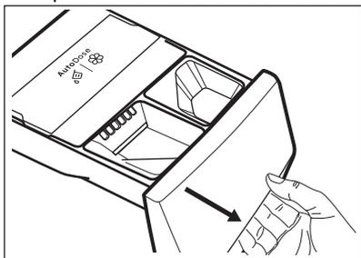
2. Mettere il detersivo in polvere nello scomparto
