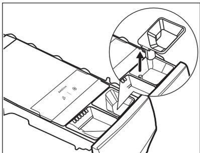
3. Premere il blocco sul retro conformemente a quanto indicato nell'immagine e sollevare il coperchio superiore per eseguire la rimozione.
