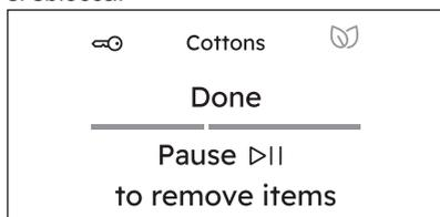
Se non viene toccato Avvio/Pausa▷||, l'apparecchiatura continua automaticamente a funzionare con la fase anti-pieghe per circa 30 minuti.
