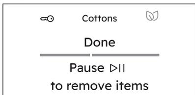
Se non viene toccato Avvio/Pausa▷||, l'apparecchiatura continua automaticamente a funzionare con la fase anti piega per circa 30 minuti.
