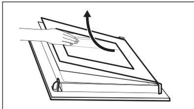
9. Pulire i pannelli in vetro con dell'acqua saponata. Asciugare il pannello in vetro facendo attenzione. Al termine della pulizia, eseguire i passaggi di cui sopra in sequenza opposta. Installare per primo il pannello
