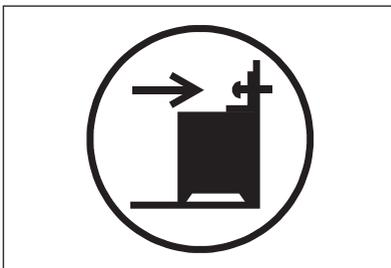
1. Installare la protezione antiribaltamento 305 - 310 mm al di sotto della superficie superiore dell'apparecchiatura e a 80-85 mm dal lato dell'apparecchiatura nel foro rotondo su una staffa. Avvitarla nel materiale solido o utilizzare il rinforzo appropriato (parete).
