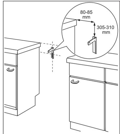
2. Il foro si trova sul lato sinistro sul retro dell'apparecchiatura. Sollevare la parte anteriore dell'apparecchiatura e collocarla al centro dello spazio tra gli armadi. Se lo spazio tra gli armadi di sostegno è superiore rispetto alla larghezza dell'apparecchiatura, regolare la misurazione laterale per posizionare l'apparecchiatura.
