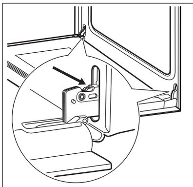
2. Alzare e ruotare le levette completamente sulle due cerniere.
