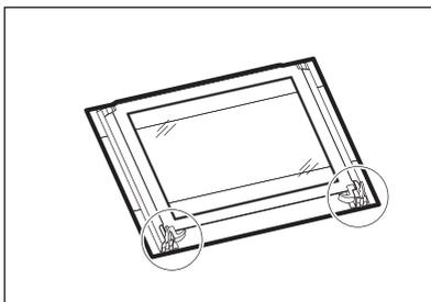
5. Sganciare il sistema di bloccaggio per rimuovere il pannello interno in vetro.
