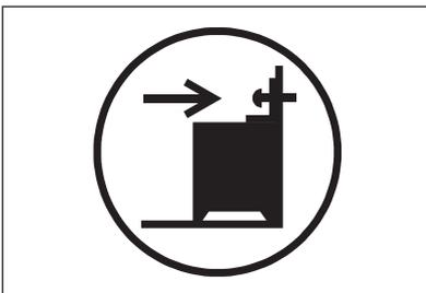
1. Installare la protezione antiribaltamento 232-237 mm al di sotto della superficie superiore dell'apparecchiatura e a 110-115 mm dal lato dell'apparecchiatura nel foro rotondo su una staffa. Avvitarla nel materiale solido o utilizzare il rinforzo appropriato (parete).
