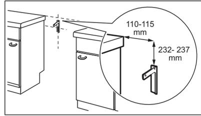
2. Il foro si trova sul lato sinistro sul retro dell'apparecchiatura. Sollevare la parte anteriore dell'apparecchiatura e collocarla al centro dello spazio tra gli armadi. Se lo spazio tra gli armadi di sostegno è superiore rispetto alla larghezza dell'apparecchiatura, regolare la misurazione laterale per posizionare l'apparecchiatura.
