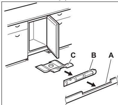
2. Pulire la griglia di ventilazione. (Vedere "Pulizia del filtro di ventilazione".)
