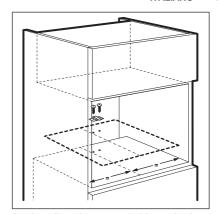
**3.** Installare il microonde Una volta fissata la staffa, assicurarsi che blocchi la parte posteriore dell'apparecchiatura.
