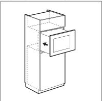
**4.** Aprire la porta e fissare il microonde al mobile mediante una vite.
