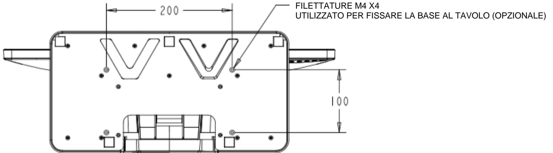
Le opzioni di montaggio della base ET2402L e ET2702L sono mostrati di seguito.
