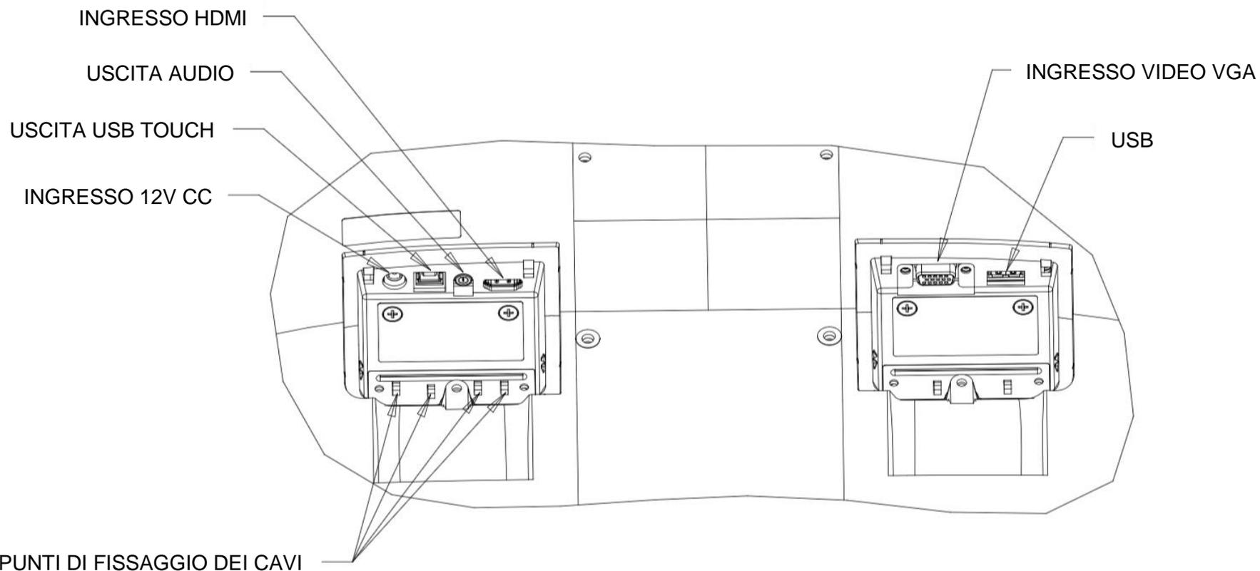
Nota: I Punti di fissaggio dei cavi possono essere utilizzati per fissare i cavi con delle fascette. È sufficiente arrotolare le fascette attorno ai punti di fissaggio dei cavi e attorno al cavo per fissare i collegamenti dei cavi.
