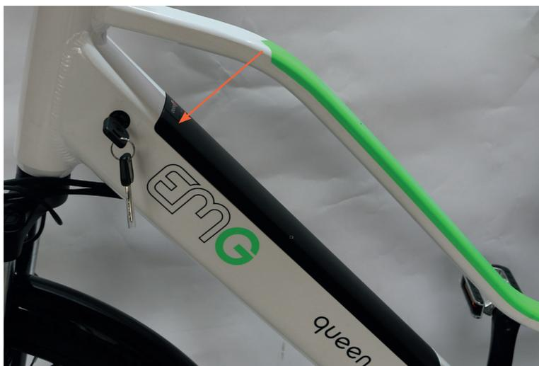
1. Inserire la batteria nel suo compartimento del telaio, partendo dalla parte bassa
