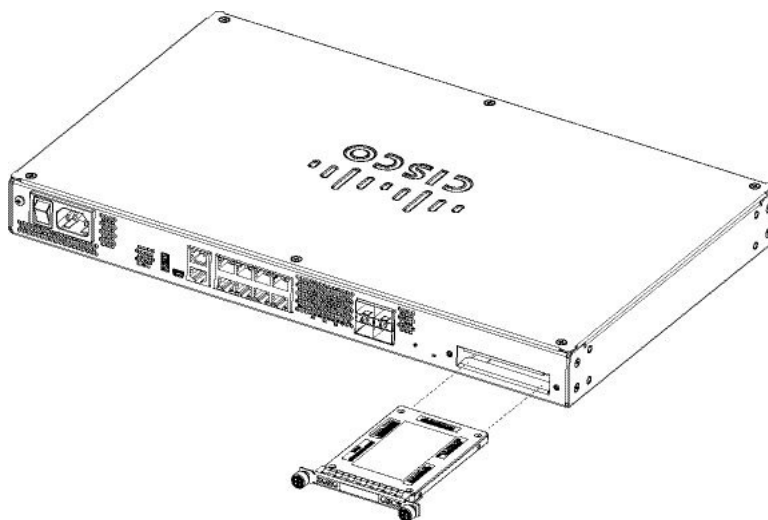
Figura 23: Rimuovere e installare un'unità SSD
