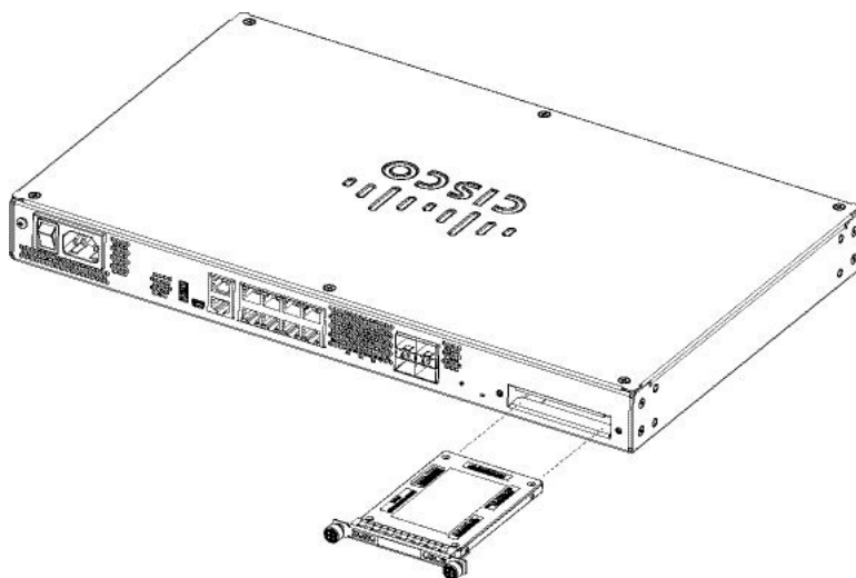
Figura 23: Rimuovere e installare un'unità SSD
