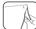
До 20 листов бумаги, скрепленных степлером: стопы бумаги, скрепленные степлером и содержащие более 20 листов, следует разделить.
