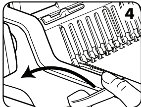
4. לאחר שכל הגליונות המנוקבים הוטענו על הספירלה, יש לדחוף את ידית הספירלה אחורה עד הסוף כדי לסגור את הספירלה - ואז אפשר להוציא מהמכשיר את המסמך הכרוך.
