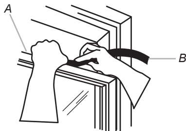
A. Estremità superiore del battente della finestra inferiore B. Guarnizione di schiuma
