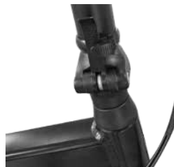
Ruotare l'anello di sicurezza per evitare che la leva di fissaggio si sblocchi accidentalmente.
