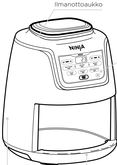
Ilmanpoisto (sijaitsee takana)
