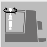
Filter in Wassertank eindrehen
