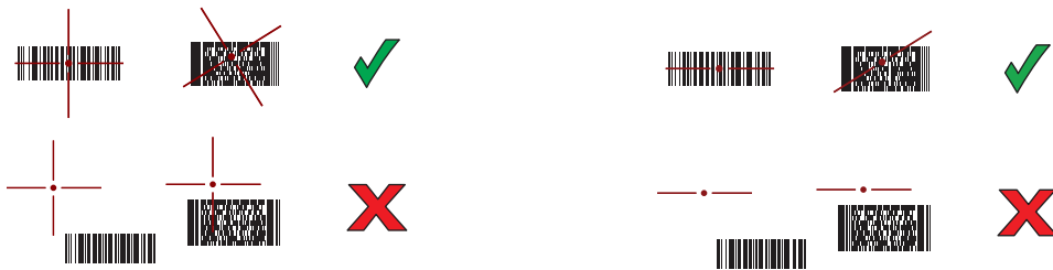
Figura 38 Reticolo di puntamento: portata standard ed estesa
