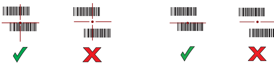
Figura 39 Modalità lista di prelievo con più codici a barre nel modello di puntamento: portata standard ed estesa
