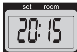
F: Wenn die 4-Stellige Zahl nicht mehr blinkt, sind die Einstellungen gespeichert.
