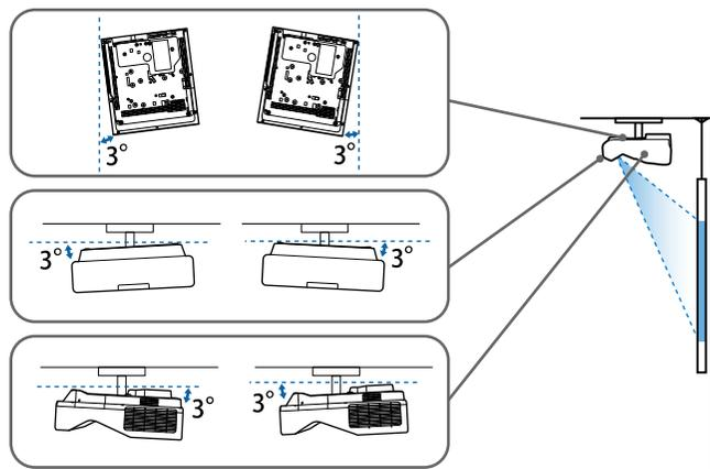
Indipendentemente dal posizionamento del proiettore, l'utilizzo del proiettore con un angolo di inclinazione superiore ai 3° potrebbe causare danni e incidenti.
