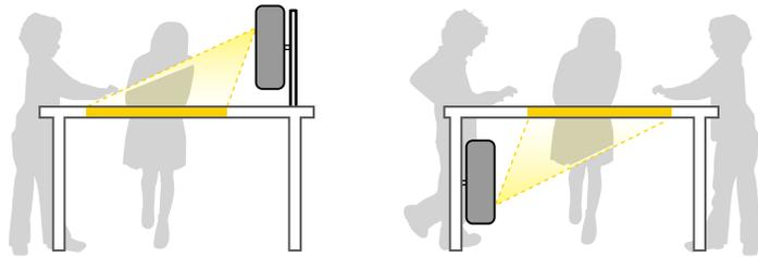
Selezionare l'opzione **Proiezione** corretta nel menu **Installazione** del proiettore a seconda del metodo di installazione in uso. Se necessario, attivare l'impostazione **Tasto direz. inversa** nel menu **Funzionamento** del proiettore e regolare l'impostazione **Rotazione del menu** nel menu **Schermo** del proiettore.
