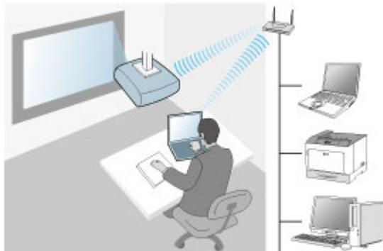
Questo proiettore contiene dei moduli LAN wireless incorporati. Se si installa un modulo LAN wireless opzionale aggiuntivo, è possibile utilizzare entrambi i metodi di connessione di rete simultaneamente. Quando si installa il modulo LAN wireless, impostare **AP semplice** su **On**.
