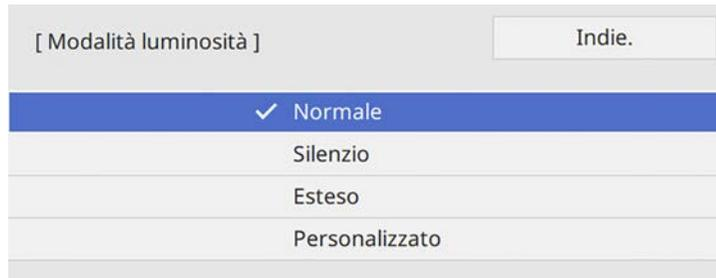
**8** Se si configura l'impostazione **Modalità luminosità** su **Personalizzato**, selezionare **Livello luminosità** e utilizzare i tasti sinistra e destra per selezionare la luminosità.
