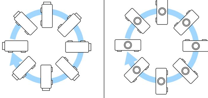
Quando si utilizzano le funzioni interattive, il proiettore può essere inclinato fino a 3°, indipendentemente dal posizionamento del proiettore (EB-735Fi/EB-725Wi).
