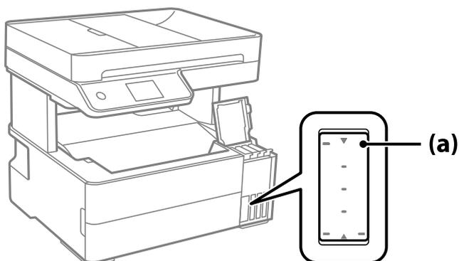
8. Allineare la parte superiore della bottiglia di inchiostro con la porta per il riempimento, quindi inserirla direttamente nella porta per versare l'inchiostro. Il flusso si interrompe automaticamente una volta raggiunta la linea superiore.
