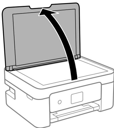
2. Pulire la superficie del vetro dello scanner con un panno morbido, asciutto e pulito.
