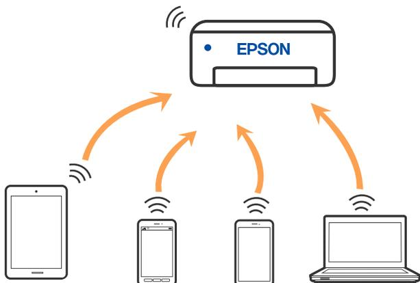
È possibile connettere la stampante simultaneamente tramite Wi-Fi e in modalità Wi-Fi Direct (AP semplice). Tuttavia, se si avvia una connessione di rete in modalità Wi-Fi Direct (AP semplice) quando la stampante è connessa tramite Wi-Fi, il Wi-Fi viene temporaneamente disconnesso.
