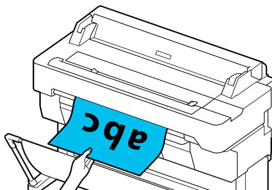
La stampa viene avviata una volta che l'originale è stato rimosso completamente.
