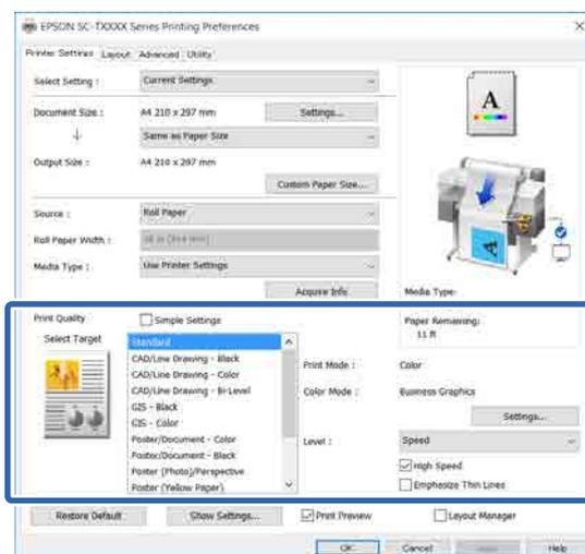
Facendo clic sul tasto **Settings (Impostazioni)** è possibile, per esempio, regolare con precisione le voci Gamma, Brightness (Luminosità), Contrast (Contrasto), Saturation (Saturazione) e il bilanciamento dei colori.
