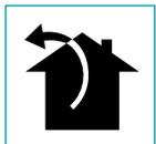
Bij deze uitvoering wordt de geur en de damp via een afvoerbuis naar buiten afgevoerd. Hiervoor dient de motoropening van de afzuigkap dmv een buis aangesloten te worden.
