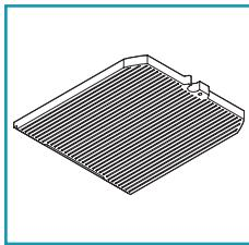
I filtri al carbone attivo hanno la funzione di trattenere gli odori presenti nel flusso d'aria che li attraversa: l'aria depurata per successivi passaggi attraverso i filtri viene rimessa nell'ambiente cucina.
