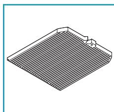
Aktiivihiilisuodattimien tehtäväänä on pidättää niiden läpi virtaavan ilman hajuja: puhdistettu ilma palautetaan keittiöön suodattimien läpi menon jälkeen.
