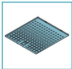
Metallfettfiltren har funktionen att hålla kvar svavande fettpartiklar: dessa sistnämnda underbläser eventuella flammor som avges under tillagningen när de avläggs på filtren och skapar dålig lukt samt försämrar luftflödet genom att minska kåpans utsugningskapacitet.
