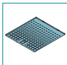
Les filtres métalliques anti-graissé ont pour fonction de retenir les particules grasses en suspension : ces dernières, déposées sur les filtres, alimentent d'éventuelles flammes dégagées pendant la cuisson, génèrent des odeurs peu agréables et compromettent le passage de l'air en réduisant la capacité d'aspiration de la hotte.
