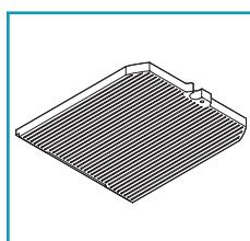
Los filtros de carbón activo tienen la función de retener los olores presentes en el flujo de aire que los atraviesa: el aire depurado mediante los pasajes a través de los filtros se vuelve a introducir en el ambiente de la cocina.
