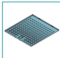
Os filtros metálicos antigordura têm a função de reter as partículas de gordura em suspensão: estas últimas, depositadas nos filtros, alimentam as eventuais chamas soltas durante o cozimento, gerando odores poucos agradáveis e comprometendo a passagem do ar e reduzindo a capacidade de aspiração da coifa.
