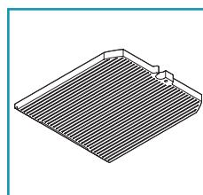
Os filtros de carvão ativado têm a função de reter os odores presentes no fluxo de ar: o ar depurado para as sucessivas passagens através dos filtros é inserida na cozinha.
