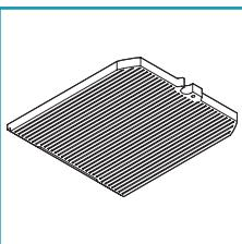
Los filtros de carbón activo tienen la función de retener los olores presentes en el flujo de aire que los atraviesa: el aire depurado mediante los pasajes a través de los filtros se vuelve a introducir en el ambiente de la cocina.
