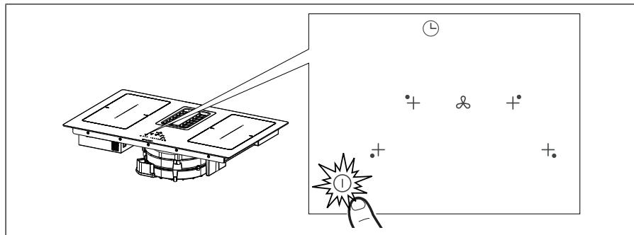
Pulse durante dos segundos la tecla de encendido/apagado ① para encender y activar las funciones de la placa. Todos los dígitos muestran  $8$ , salvo los del temporizador en los que se visualiza "CL".
