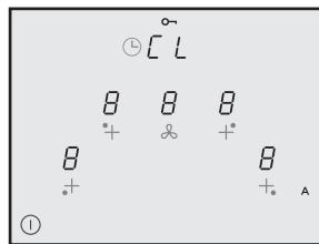
Entonces, la placa está encendida, pero no hay potencia ni en las zonas de cocción ni en la campana. La placa se apaga automáticamente si transcurren 20 segundos sin usarla.
