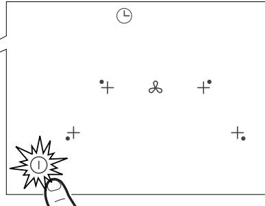
Druk 2 seconden op de On/Off-toets ① om de functies van de kookplaat in te schakelen en te activeren. Alle digits tonen 0. En die van de timer ' C L '.
