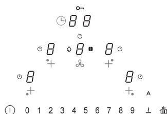
Het gebruikersmenu dient ervoor om de signaleringen van de kookplaat naar believen van de gebruiker in te stellen. Het gaat hierbij om zowel akoestische (toon en volume) als visuele signaleringen.
