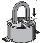
**Atención:** utilice solo recipientes con fondo perfectamente plano y adecuado para zonas de cocción por inducción. El uso de recipientes con un fondo irregular puede perjudicar la eficiencia del sistema de radiación de calor y dificultar la detección de la presencia del recipiente en la zona de cocción.
