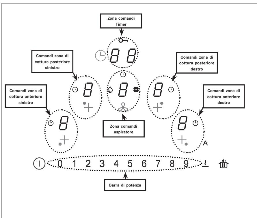
I comandi delle zone di cottura, dell' aspiratore e il timer possono essere attivati premendo sul Digit di riferimento **8**.
