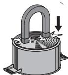
**Attenzione:** utilizzare esclusivamente pentole con fondo perfettamente piano e adatto a zone di cottura a induzione. L'utilizzo di pentole dal fondo irregolare può minare l'efficienza del sistema di radiazione del calore e può ostacolare il rilevamento di presenza pentola sulla zona di cottura.
