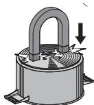
**Achtung:** Verwenden Sie nur Töpfe mit einem perfekt flachen und für Induktionskochbereiche geeigneten Boden. Die Verwendung von Töpfen mit unebenem Boden kann die Effizienz des Wärmestrahlungssystems beeinträchtigen und das Erkennen eines Topfes auf dem Kochbereich behindern.
