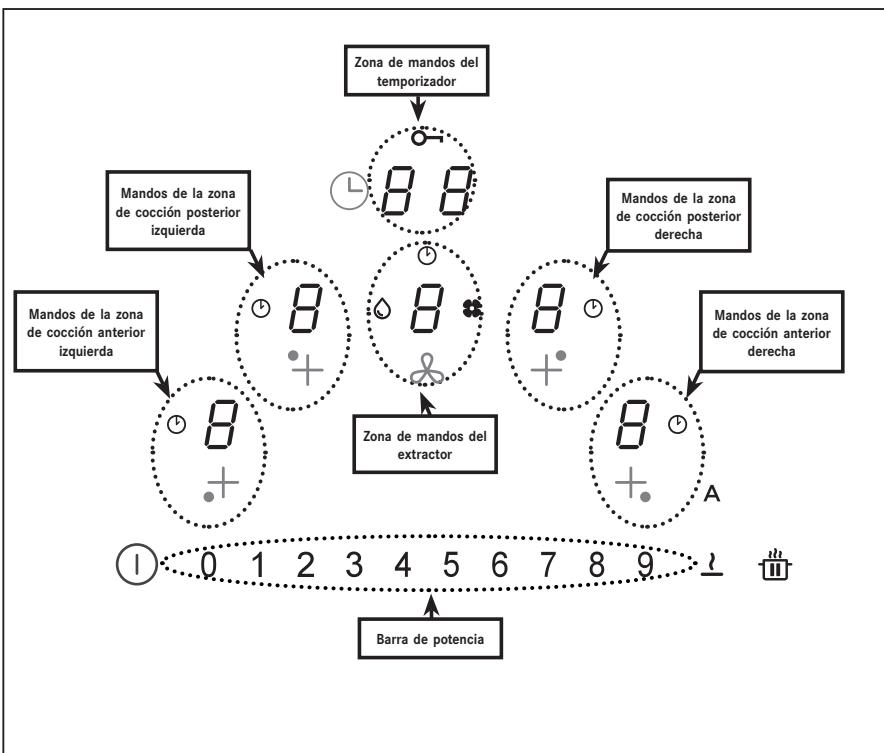
Los mandos de las zonas de cocción, del extractor y del temporizador se pueden activar pulsando el dígito de referencia **B**.
