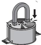
**Let op:** gebruik uitsluitend pannen met een perfect platte bodem die geschikt is voor inductiekookzones. Het gebruik van pannen met een onregelmatige bodem kan de efficiëntie van het warmtestralingsysteem ondermijnen en kan de pandetectie op de kookzone verhinderen.
