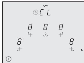
In questo momento il piano è acceso ma tutte le zone di cottura e la cappa sono a potenza zero. Il Piano si spegne automaticamente dopo 20 secondi di inutilizzo.
