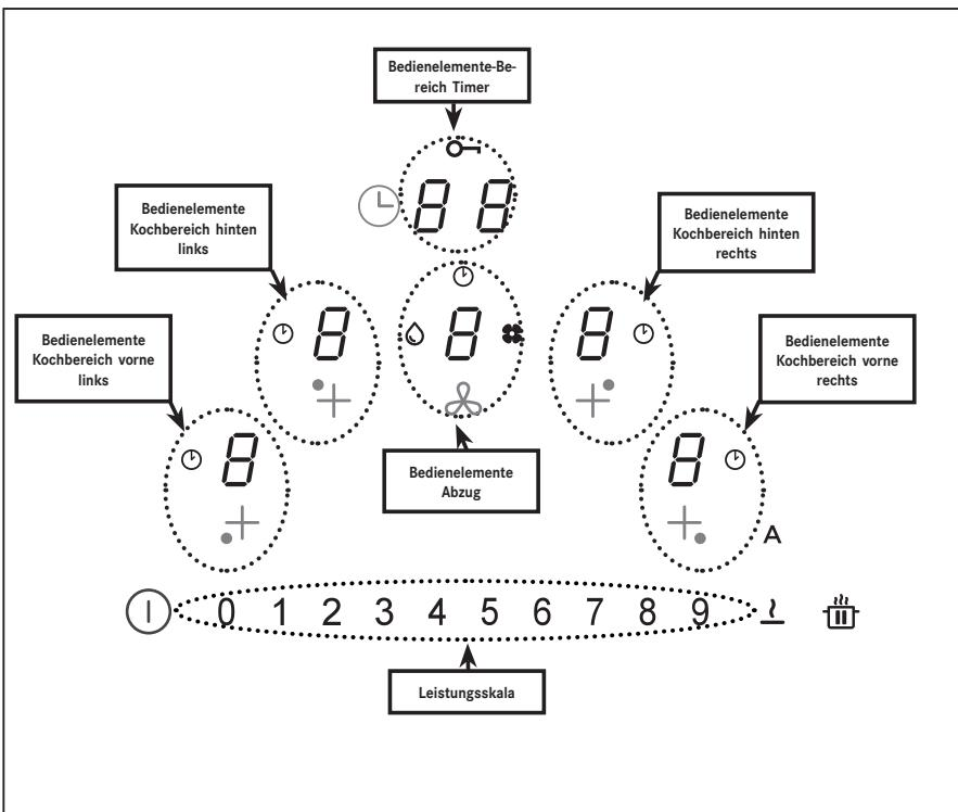
Die Bedienelemente der Kochbereiche, des Abzugs und des Timers können durch Drücken der Referenz-Digit-Taste aktiviert werden **B**.
