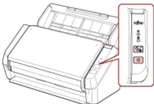
Dopo che l'indicatore di alimentazione lampeggia per un po', lo scanner si spegne e l'indicatore di alimentazione si spegne.
