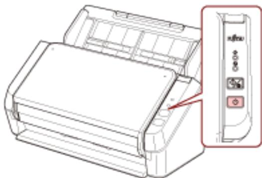
Lo scanner si accende e, durante l'inizializzazione, l'indicatore di alimentazione lampeggia in verde. Quando l'indicatore di alimentazione si accende in verde, lo scanner è pronto per la scansione. Ciò è definito stato di "pronto".
