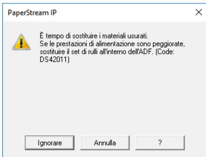
Verificare il messaggio e sostituire conseguentemente il materiale usurabile.
