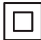
Este aparato, para su seguridad, ha sido diseñado con un doble aislamiento. **CE**
