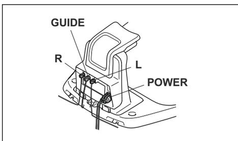
3. Invertire i collegamenti tra il cavo guida e il cavo perimetrale sulla stazione di ricarica. Iniziare invertendo i collegamenti L e GUIDE. Se la spia è gialla e lampeggiante, l'interruzione si trova in un punto del cavo perimetrale compreso tra L e il punto in cui il cavo guida è collegato con il cavo perimetrale (linea nera spessa nella figura).
