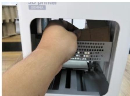
Steek de filamentgeleidebuis in de zwarte pneumatische connector bovenop de extruder.
