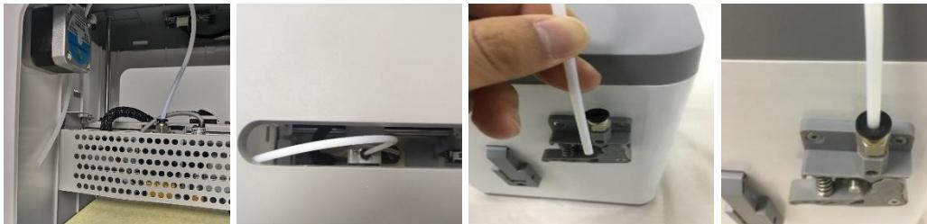
Asegúrese de que el interruptor de alimentación del adaptador de alimentación de CA esté en la posición de APAGADO (O). Enchufe el conector cilíndrico de CC del adaptador de alimentación de CA en el puerto de alimentación del lado derecho de la impresora. Enchufe el cable de alimentación de CA incluido en el adaptador de alimentación de CA, luego conecte el otro extremo a una toma de corriente de CA cercana.
