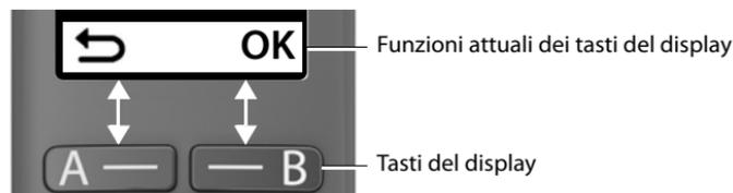
► Premere il tasto del display . . . viene richiamata la funzione visualizzata al di sopra sul display.
