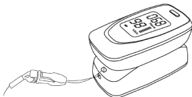
Figura 4. Montaggio del cordino di supporto
