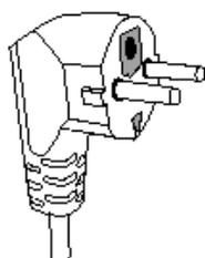
Dieses Gerät ist mit einem Erdungsoutlet ausgestattet und muss an einer passenden Steckdose geerdet werden.
