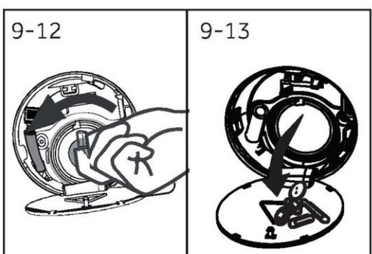
9. Pulire accuratamente il filtro della pompa, ad es. con acqua corrente (Fig. 9-14).
