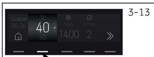
1. Toccare il pulsante "Temp." (Fig.3-13) per selezionare una temperatura diversa (--/20/30/40/60/90).
