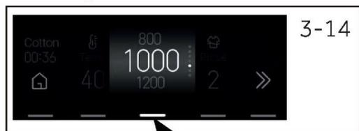
1. Toccare il pulsante "Velocità" (Fig.3-14) per selezionare una velocità diversa (0/400/600/800/1000/1200/1400).
