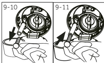
3. Disporre di un contenitore piano per raccogliervi l'acqua (Fig. 9-10). Il quantitativo di acqua potrebbe essere importante!
