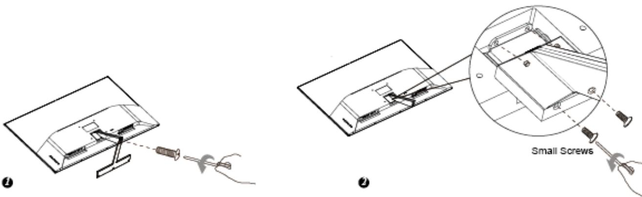
Figura.1. Installazione e Rimozione della Base
