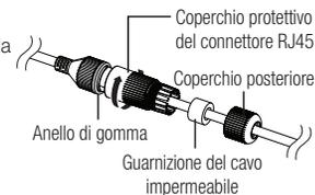
5. Mettere insieme le parti facendo ruotare il coperchio protettivo RJ45 e il coperchio posteriore in senso orario (Seguire la direzione della freccia).
