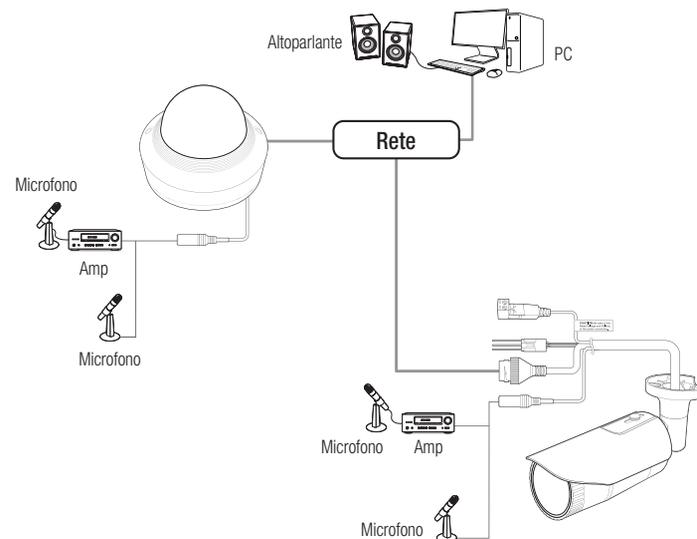
1. Collegare la porta AUDIO IN della telecamera con il microfono o alla porta LINE OUT.
