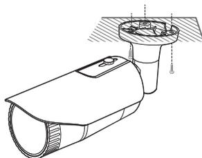
4. Regolare la direzione della telecamera usando la chiave a L in dotazione.
