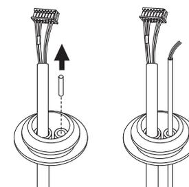
4. Inserire il cavo di allarme/audio nel foro creato dopo la rimozione della boccia per cavi al Punto 2. Collegare i cavi, rispettivamente, al terminale di allarme/audio e alla morsettiera di alimentazione del circuito stampato.
