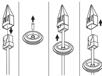
5. Inserire il cavo LAN nel foro creato dopo la rimozione della boccia per cavi al Passaggio 2, e collegarlo al terminale Ethernet.
