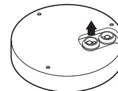
3. Estrarre la piccola parte estrusa sulla boccia del cavo di allarme/ audio e inserire il cavo di alimentazione nella boccia.
