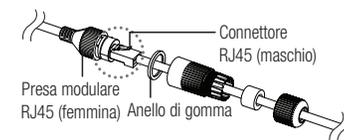
4. Eseguire l'installazione facendo ruotare la presa modulare RJ45 (femmina) e il coperchio di protezione RJ45 in senso orario (seguire la direzione della freccia).
