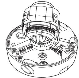
3. Inserire il cavo di alimentazione nel piccolo foro creato dalla rimozione della parte della spina di gomma integrata nel passaggio n. 2 mostrato sopra e riporre il cavo nella lunga scanalatura.
