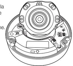
5. Inserire il cavo LAN nel foro creato dalla rimozione della parte della spina di gomma integrata nel passaggio n. 2 mostrato sopra.
