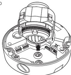
3. Inserire il cavo di allarme/audio nel foro creato dalla rimozione della spina di gomma nel passaggio 2 e collegare il cavo con il terminale di allarme.
