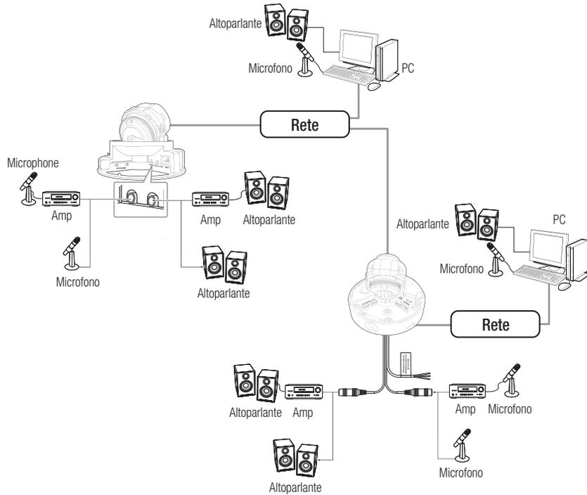
1. Collegare la porta AUDIO IN della telecamera al microfono o alla porta LINE OUT dell'amplificatore a cui è collegato il microfono.
