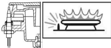
L'apparato termico attiva il meccanismo di sicurezza intercettando il gas nel caso di spegnimento dei bruciatori in seguito al trabocco di liquidi
