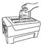
injeção de água
