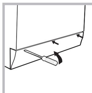
3. rimuovere il pannello di copertura sul lato anteriore della lavabiancheria con l'ausilio di un giravite (vedi figura).
