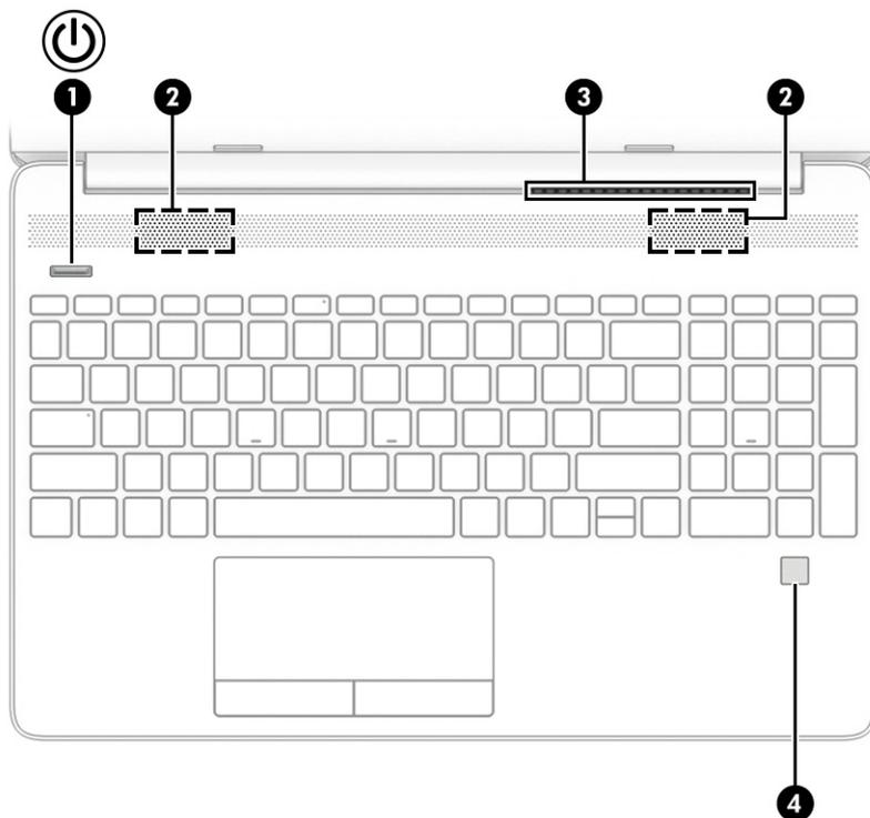
I lettori di impronte digitali, che abilitano l'accesso tramite riconoscimento dell'impronta digitale, possono essere situati sul touchpad, su un pannello laterale del computer oppure sul coperchio superiore sotto la tastiera.
